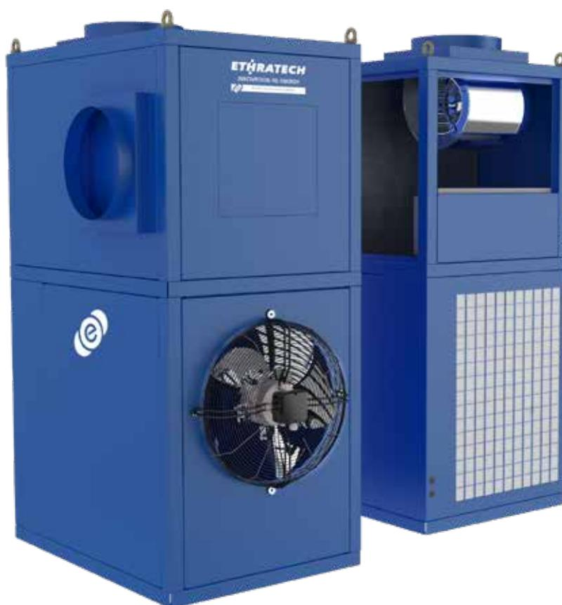
Climatiseurs monoblocs pour une utilisation dans des espaces intérieurs, avec condensation à air, spécialement réalisés pour opérer dans des environnements industriels, poussiéreux et à températures élevées. Parfaits pour refroidir des conteneurs et des cabines électriques par canalisation.
