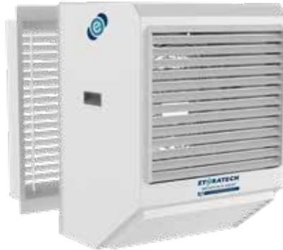
Il sistema Free cooling ha la caratteristica di garantire continui ricambi di aria con l'obiettivo primario di trasferire verso l'ambiente esterno il calore generato dagli apparati (per dissipazione). Soluzione studiata per consentire RISPARMIO ENERGETICO anche in quei siti dove siano stati precedentemente installati condizionatori sprovvisti di sistema freecooling.
