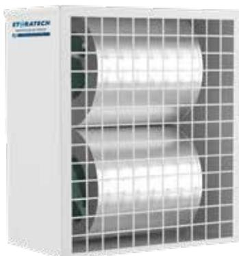
Le système Free-cooling a la caractéristique de garantir des renouvellements d'air continus avec l'objectif principal de transférer vers l'extérieur la chaleur générée par les appareils (par dissipation). Solution étudiée pour permettre une ÉCONOMIE D'ÉNERGIE même là où des climatiseurs dépourvus de système free-cooling ont été précédemment installés.
