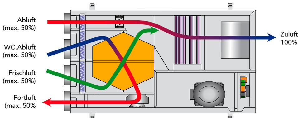
Mit dieser gewählten Betriebsart erneuert der GHE die Raumluft. Die verbrauchte Luft wird durch den hocheffizienten Kreuzstromwärmetauscher nach Aussen abgeführt. Gleichzeitig wird der Zuluftstrom erhöht, um den Betrieb des Kältemittelkreislaufs zu ermöglichen. Für diesen Zweck wird die Rückluftklappe geöffnet und der Zuluftventilator wird auf die maximale Leistung hochgefahren. Der GHE arbeitet nun mit Außenluft und einem Teil Umluft.
