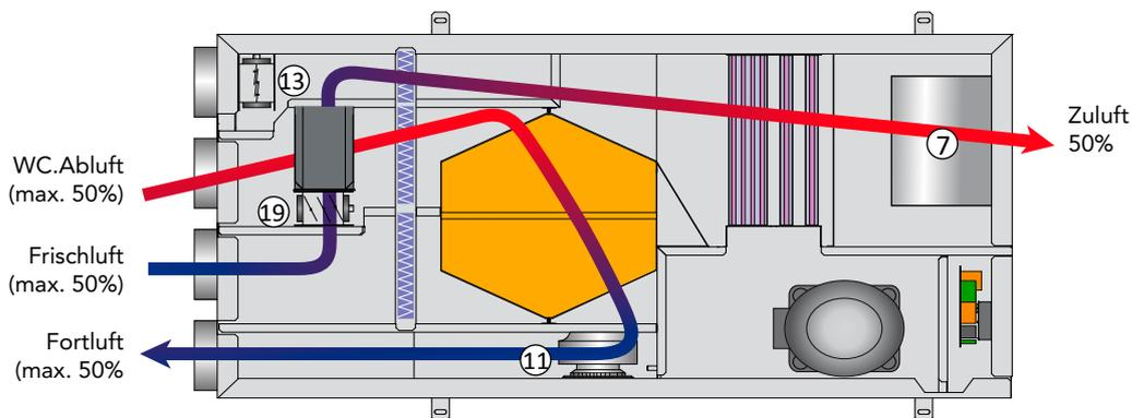
Der Verdichter ist ausgeschaltet, das Wasserregister geschlossen (3- Wege- Ventil geschlossen), Umluftklappe (13) wird geschlossen, die Bypassklappe der Wärmerückgewinnung (19) ist geöffnet. Die verbrauchte Abluft wird vom Ventilator (11) nach außen abgeführt. Währenddessen wird Außenluft (Frischlufte) durch den Ventilator (7) angesaugt, über die Bypassklappe an
