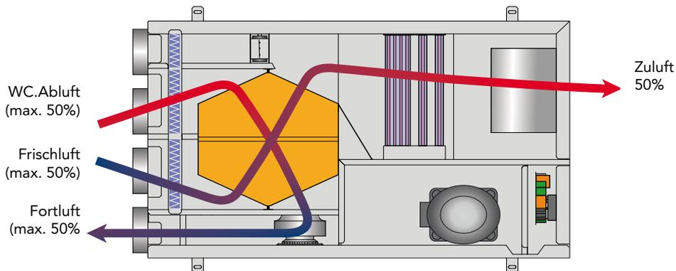
Bei dieser gewählten Betriebsart, erneuert der GHE die Raumluft in dem die verbrauchte Luft nach außen durch den hocheffizienten Kreuzstromwärmetauscher abgeführt wird. Der Luftstrom wird um den erforderlichen Wert reduziert (Standard 0,3 ÷ 0,5 Vol. / h), die Umluftklappe ist geschlossen und der GHE arbeitet mit 100% Frischluft.
