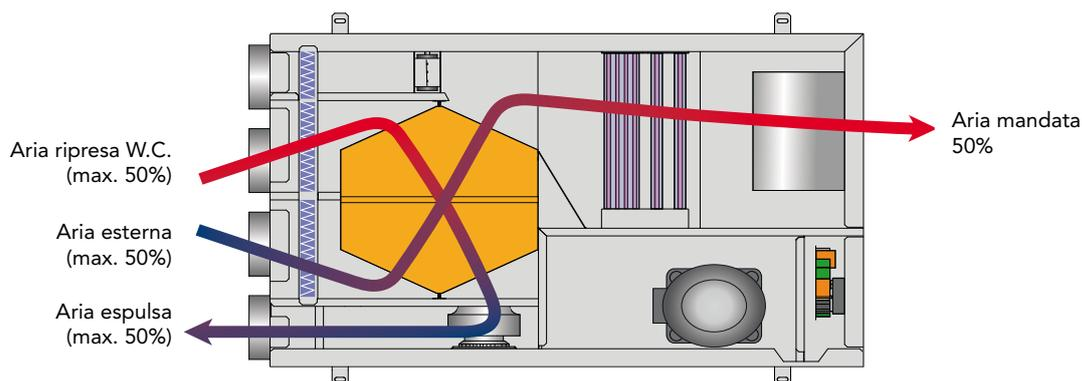
Impostando questa modalità di funzionamento, l'unità rinnova l'aria ambiente con quella esterna attraverso il recuperatore di calore ad altissima efficienza.
