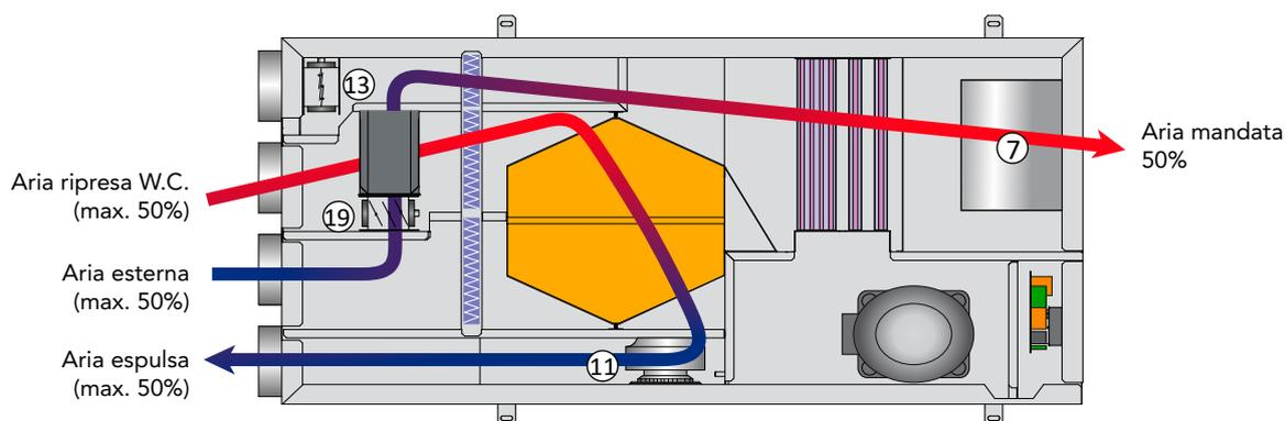
Il compressore è spento, la batteria ad acqua non è alimentata (valvola a 3 vie chiusa), la serranda di ricircolo (13) è chiusa, la serranda di by-pass del recuperatore (19) è aperta. L'aria viziata viene espulsa all'esterno dell'ambiente tramite il ventilatore (11) mentre l'aria esterna, aspirata dal ventilatore (7) by-passa
