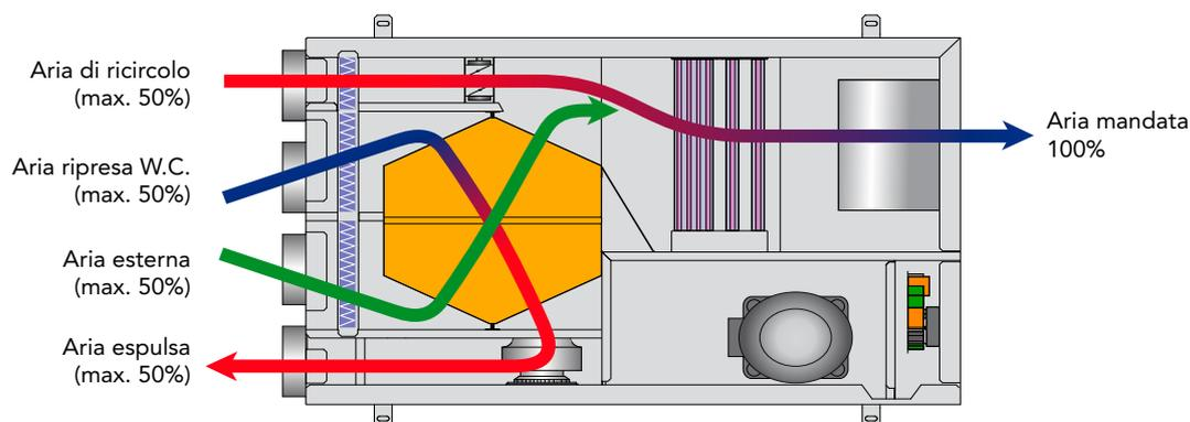
Impostando questa modalità di funzionamento, l'unità rinnova l'aria ambiente con quella esterna attraverso il recuperatore di calore ad altissima efficienza, la portata d'aria viene aumentata in modo da permettere il funzionamento del circuito frigorifero; a questo scopo viene aperta la serranda di ricircolo, il ventilatore di mandata viene gestito a portata massima e l'unità lavora con aria esterna e parziale ricircolo.
