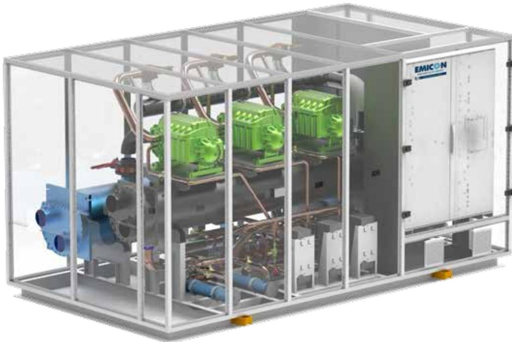
Las unidades de la serie RWH Ka-Kh-Ke son enfriadoras de líquido y bombas de calor que funcionan con gases R1234Ze y R513A refrigerados por agua y están equipadas con intercambiadores de carcasa y tubo, compresores de tornillo semi herméticos. En función de la potencia frigorífica requerida, están disponibles en versiones monocompresor o multicompresor con 1 y 2 circuitos frigoríficos independientes y doble circuito hidráulico.
