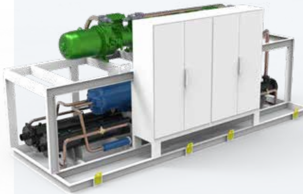
REFRIGERATORI MONOBLOCCO AD AMMONIACA CONDENSATI AD ARIA CON COMPRESSORI VITE Installazione esterna, elevate capacità di raffreddamento Serie ORCA Potenza frigorifera da 200 kW a 2500 kW
