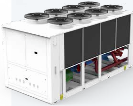
REFRIGERATORI CONDENSATI AD ARIA PER INSTALLAZIONE ESTERNA con compressori Vite inverter, ventilatori assiali e batterie condensanti a microcanale Serie RAH MC VS Potenza frigorifera da 306 kW a 1555 kW
